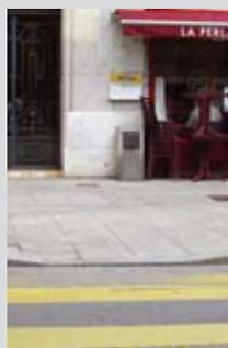
A la hauteur des traversées piétonnes et aux entrées carrossables, le dévers peut exceptionnellement atteindre 6% à cause de l'abaissement du trottoir. Lorsque cette limite est dépassée aux traversées piétonnes, la pose d'une main courante sur le bord intérieur du trottoir (côté opposé à la chaussée) peut rassurer certains piétons.
