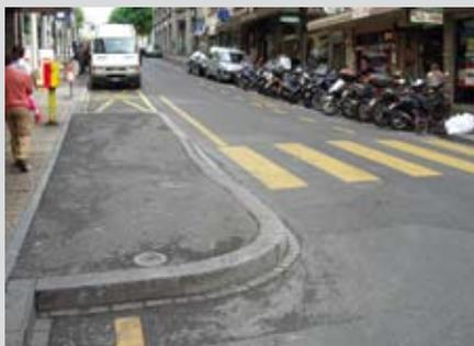
L'**avancement de la zone d'attente** (mise en place d'un bastion) comporte plusieurs avantages : elle resserre la chaussée, obligeant les automobilistes à ralentir, réduit la distance de traversée et offre au piéton une meilleure visibilité.
