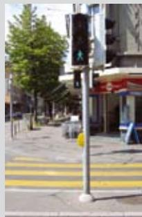
Un poteau positionné au milieu de la zone d'attente (photo de gauche) ou d'un îlot intermédiaire (photo de droite) rend les dispositifs tactiles accessibles aux droitiers et aux gauchers.
