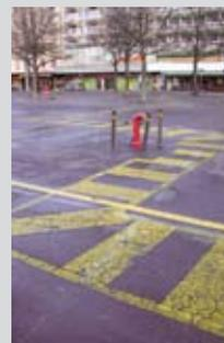
Dans les **zones de rencontre** sans trottoirs ou autres éléments architecturaux structurants, la mise en place d'un système de lignes de guidage peut se révéler nécessaire. Le système doit être simple et prévoir un endroit où la personne aveugle ou malvoyante peut traverser la chaussée.
