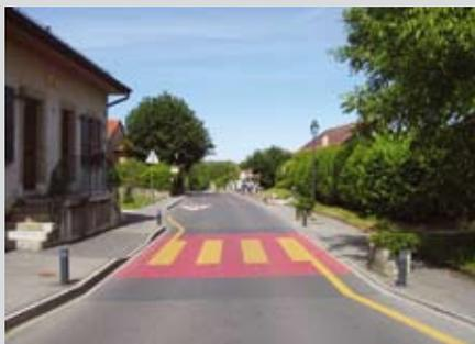
Un **rétrécissement latéral** incite les conducteurs à ralentir et facilite la traversée des piétons.
