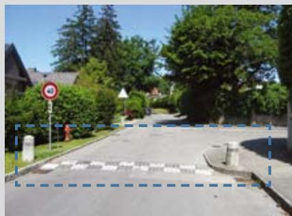
Un **rétrécissement latéral de la chaussée** doit être aménagé avant le tronçon de rue sans trottoir pour obliger les conducteurs à ralentir (photo de gauche).
