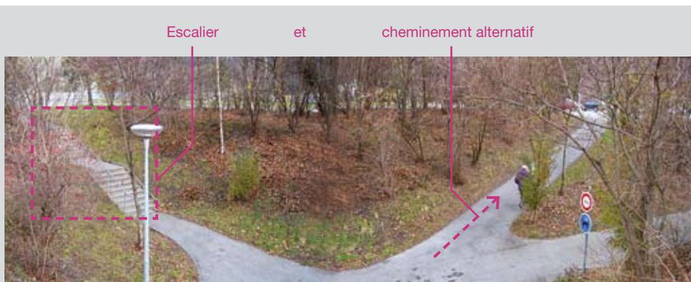
Si l'aménagement d'une rampe à côté de l'escalier n'est pas possible, un parcours alternatif sans marches et d'une longueur non supérieure à 60 m doit être offert aux piétons. Au-delà de cette distance, le détour peut se révéler fatigant pour certains d'entre eux.
