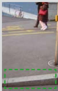
Poser le poteau de signalisation à l'une des extrémités de la zone d'attente comporte deux désavantages : le trottoir n'est souvent pas suffisamment abaissé (photo de droite) et, en l'absence de signal acoustique indiquant la direction à suivre, la personne aveugle pourrait traverser la chaussée en dehors des bandes jaunes et ne pas retrouver la zone d'attente en face.
