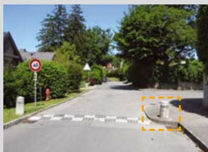
Pour renforcer l'effet de modération du trafic, le rehaussement ponctuel de la chaussée peut être combiné à un rétrécissement latéral.
