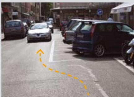
Un **décrochement horizontal** peut être obtenu par l'aménagement de places de stationnement.
