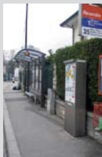
Une disposition du mobilier en ligne sur le bord intérieur du trottoir (photo de gauche) permet de ne pas encombrer le passage (contrairement aux photos de droite).
