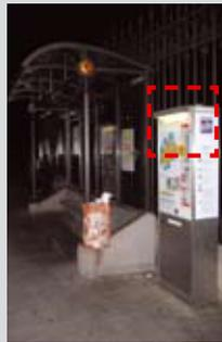
Très fréquemment, le seul éclairage d'un arrêt de bus est celui du distributeur de billets. Il est insuffisant, d'autant plus lorsque l'arrêt est éloigné d'un lampadaire de l'éclairage public.
