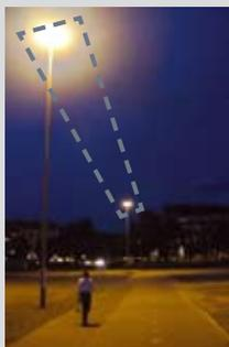
Sur les grands espaces, la disposition des lampes sert à éclairer les éléments de guidage (éléments architecturaux, lignes de guidage et autres points de repère) et à indiquer la direction aux personnes malvoyantes ou dont le sens de l'orientation est peu développé.
