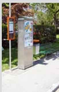
Aux arrêts de tram ou de bus, disposer le mobilier (banc, assis-debout, panneau d'information et poubelles) de manière à ne pas entraver l'accès au distributeur de billets et à ne pas réduire la **surface de manœuvre** nécessaire à une personne en fauteuil roulant, comme c'est le cas sur cette photo.
